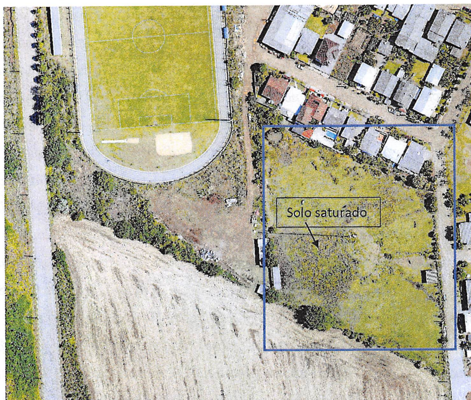
Imagem 04. Foto aérea realizada por drone, onde observa-se que a área apresenta-se com zonas de saturação.
